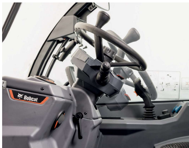
Neig- und ausziehbare Lenksäule
