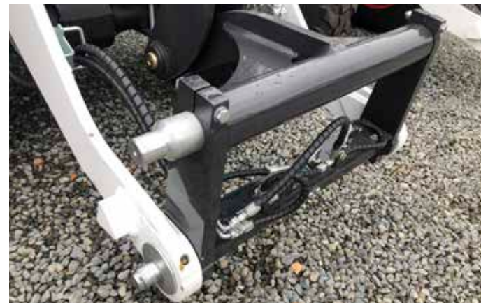
Quick-Tach-Kupplung (serienmäßig installiert)
