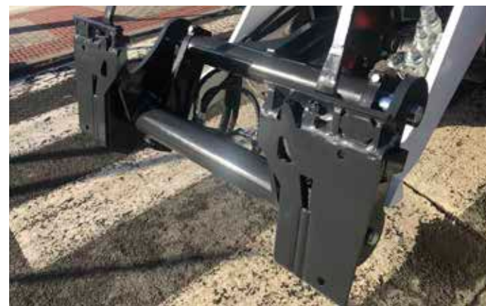
Adapter Quick-Tach auf Bob-Tach (für alle Anbaugeräte erforderlich, außer Schaufeln und Palettengabeln)
