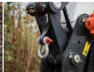
Schnellwechsler mit Bolzenbefestigung
