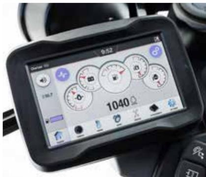
Optionaler 7-Zoll-Touchscreen mit Bluetooth-Funktion, Freisprecheinrichtung und Medien-Streaming. Automatischer Wechsel in den Nachtmodus bei schwachen Lichtverhältnissen.
