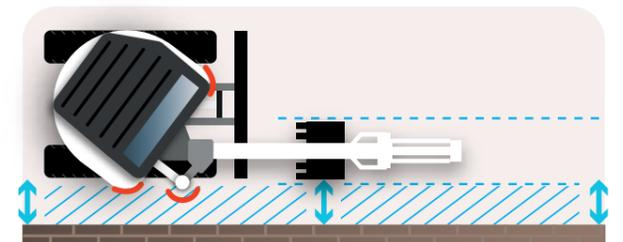
Kurzheckbauweise (Zero Tail Swing – ZTS)
