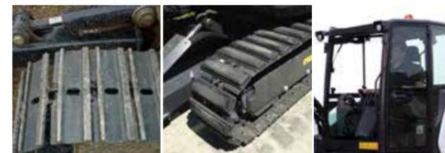
Stahlraupen Segmentierte Raupen TOPS/ROPS/FOPS-Kabine mit Heizung
