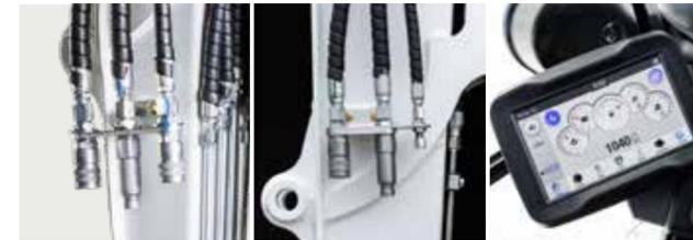
1. Zusatzhydraulik am Arm 2. Zusatzhydraulik mit Ablassleitung 7-Zoll-Display
