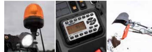
Kennleuchte mit Heckleuchte Bluetooth-MP3-Radio Klammer mit AUX1-Umlenkenventil
